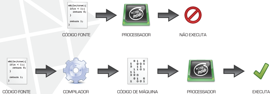
Figura 1.11: Processo de compilação e execução de um programa
